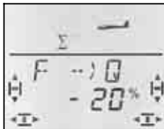
Schieber hinten: beide Querruder nach unten
