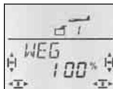
Servoweg Servo 1 für ... ... Knüppel links
