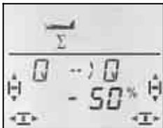
Knüppel nach links: Querruder rechts nach unten
