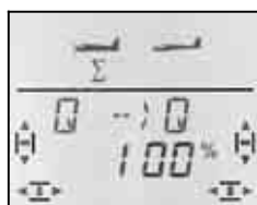
Knüppel nach rechts: rechtes Querruder nach oben
