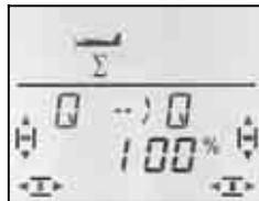
Knüppel nach rechts: Querruder rechts nach oben
