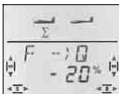
Schieber hinten: beide Querruder nach unten
