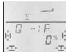
Knüppel nach links: rechte Klappe kein Ausschlag
