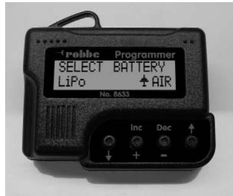
Die Bedienung des Programmers ist denkbar einfach. Mit den äußeren Pfeil Tasten entweder nach unten oder nach oben springen um in den Programmier-Modi ihrer Wahl zu gelangen. Außerdem wechselt man mit ihnen den Modeltyp, indem man beide Pfeiltasten gedrückt hält. Die beiden mittleren Tasten DEC (-) und INC (+), dienen zur Auswahl bzw. zum Ändern einer Einstellung.
