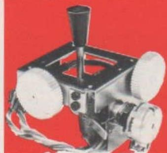
**Senderausbausatz I** (Kreuzknüppel links) zur Erweiterung von Multiplex-Digitron-2-Kanal-Sendern in 4-Kanal-Sender. Einbau: Einschrauben im Sendergehäuse und Einstecken in der Senderplatine.
